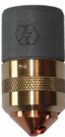
Les consommables Razor Cut vous permettent de couper les saillies, les pattes et les ailettes, aussi près que possible de la base, sans percer ni endommager la pièce, en laissant un minimum de résidus. L'angle de l'arc de 45 degrés augmente les chances de réutilisation des pièces découpées.
